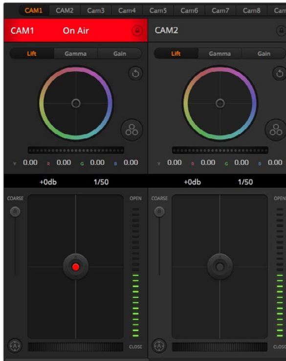
Eine rot leuchtende Blenden-/Schwarzwert-Steuerung zeigt an, dass die jeweilige Kamera auf Sendung ist
