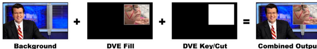
Combiner un arrière-plan avec une source fill DVE et une source key/cut DVE
