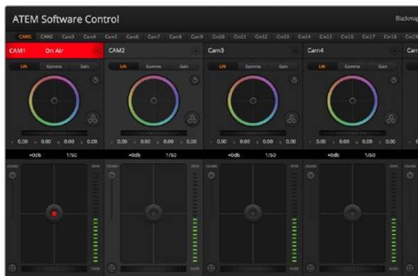
Fonction Camera Control de l'ATEM
