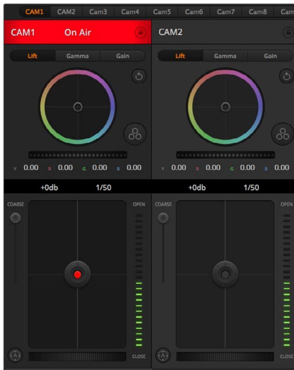
El control del diafragma/pedestal se enciende en rojo cuando la cámara correspondiente está al aire.
