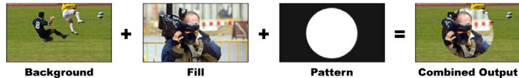
バックグラウンドとフィルおよびパターンキーの結合
