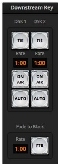
Incrustation en aval et fondu au noir
