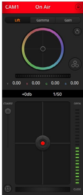
Mit ATEM Camera Control lassen sich Blackmagic Studio Cameras über Ihren ATEM-Mischer steuern.
